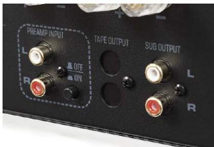
Oprócz wejść liniowych są dwa wyjścia niskopoziomowe – dla zewnętrznej końcówki mocy i subwooferów.
