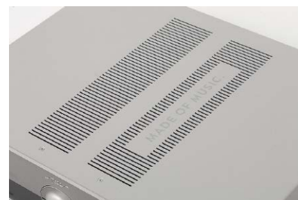
Przez środek górnej pokrywy przechodzą dwa rzędy szczelin wentylacyjnych, ale tylko lewe znajdują się nad radiatorami końcówek.
